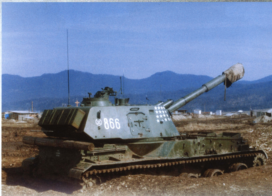
152-мм самоходка «Акация», 2001 год. На корме машины закреплено бревно самовытаскивания, на задней части башни — ящики.
